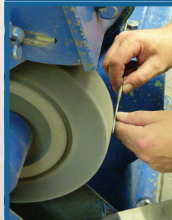
Polieren des Fühlers
